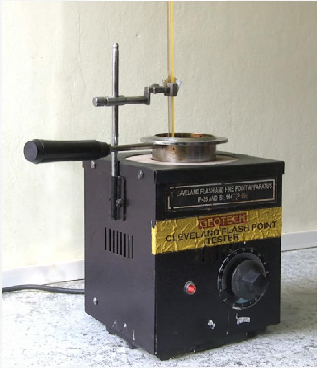
Aquí lo que se busca es utilizar una llama pequeña o chispa para provocar la ignición de los vapores del líquido; se registrará como punto de inflamación la temperatura en la que esto suceda.
